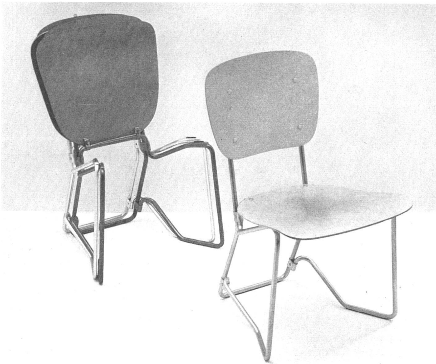
Stühle in Aluminium, ineinanderstellbar. Mehrzweckform (für Garten, Vortragsräume, Schulen usw.). Sitz mit Feder aufklappbar, elastische Rückenlehne aus 3 mm Flugzeugsperrholz angehängt. Aluminium nicht geschweißt, sondern mit Spezialverbindungen zusammengehalten. Entwurf und Ausführung: AG. Hans Zollinger Söhne, Zürich | Chaises en aluminium, pouvant s'emboîter l'une dans l'autre, forme adaptée à des buts divers (jardin, salle de conférence, écoles, etc.). Siège mobile à ressort, dossier élastique en contreplaqué d'aviation de 3 mm. Tubes d'aluminium non soudés à fixations spéciales. Hans Zollinger Fils, S.A., Zurich | Stackable aluminium chairs for multiple uses (garden, lecture halls, schools etc.). The seats have springs and can be put up. The resilient backs are made of airplane ply-wood 3 mm thick. The aluminium is not welded but joined by a special fixation. AG. Hans Zollinger Sons, Zurich
