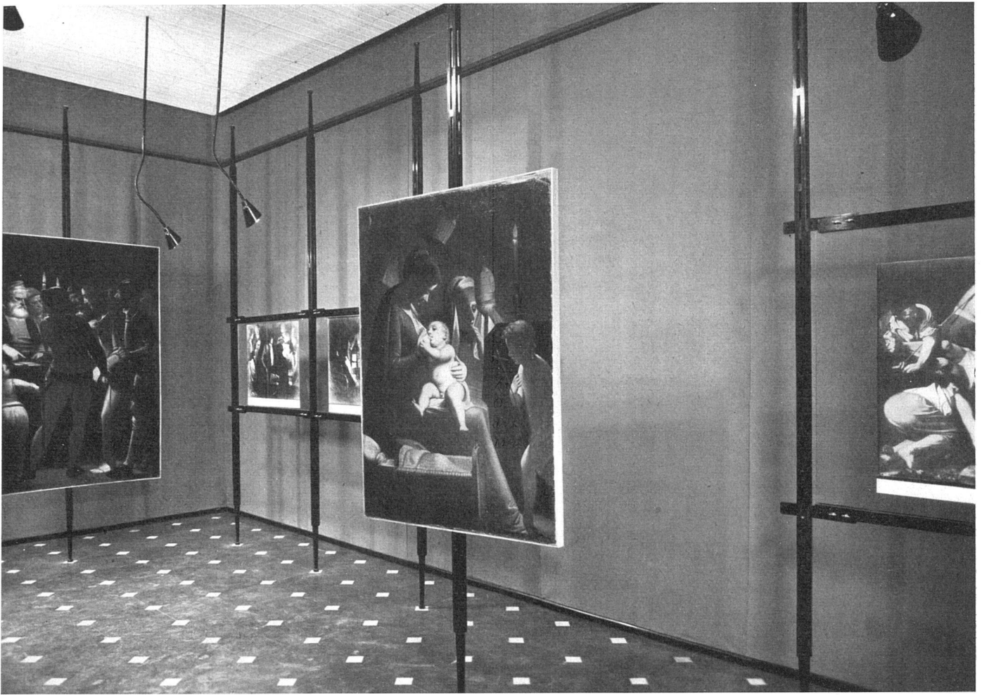
Galleria di Palazzo Bianco in Genua, Raum für Wechselausstellungen. Das mobile, von der Wand unabhängige Stützensystem bietet reiche Kombinationsmöglichkeiten | Salle des expositions temporaires. Un système de supports mobiles, indépendants des murs, offrent d'innombrables possibilités | Room for temporary exhibitions. The system of mobile supports independent of the wall offers rich possibilities of combination
