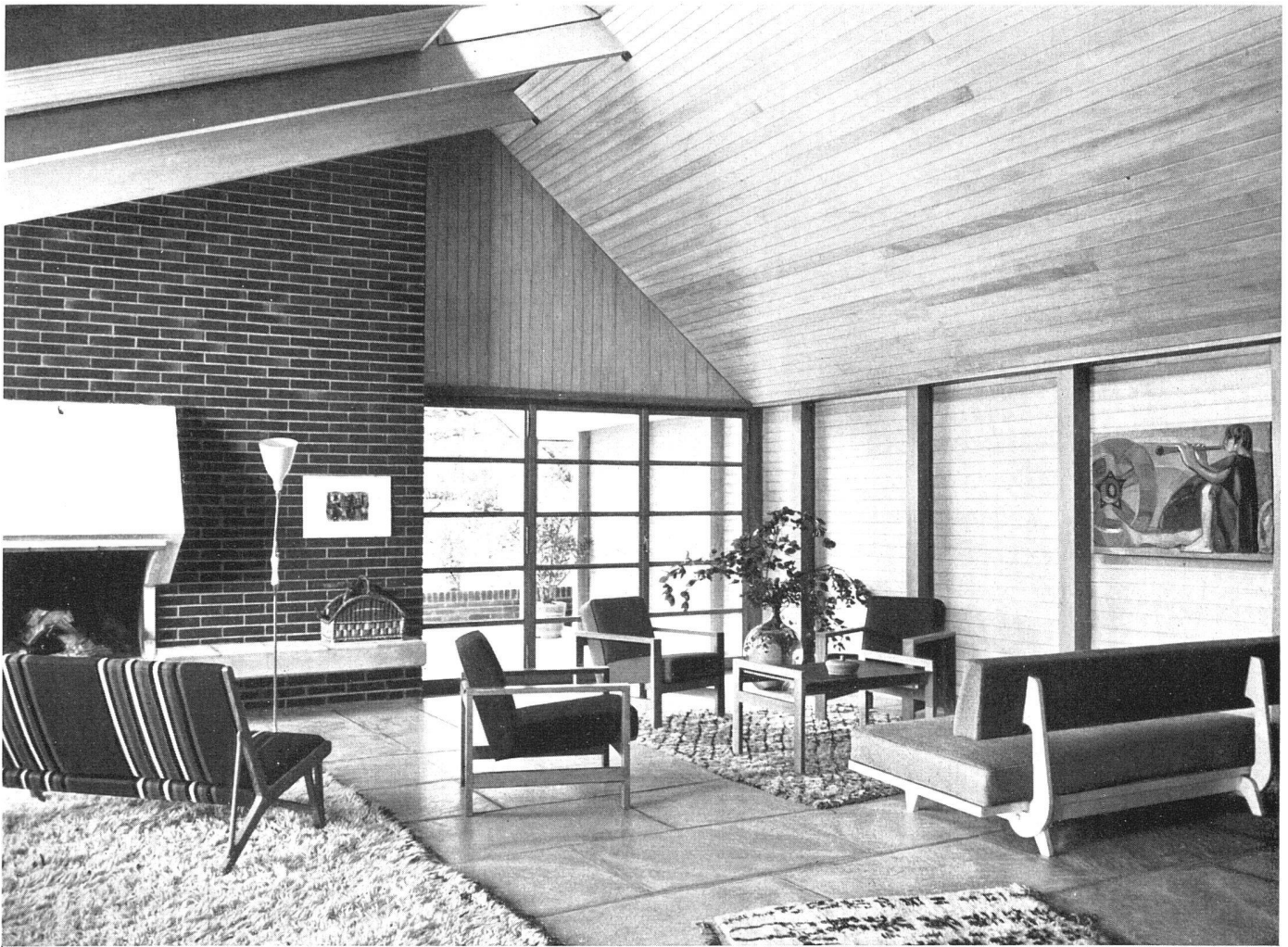
Der Musiksaal, Glastüren nach der Gartenhalle. Schöner Zusammenklang der Materialien: Muschelkalk-Bodenplatten, Klinkersteine, Tannentäfer, Eichenpfosten, weiß verputzte Kaminhaube / La salle de musique; belles proportions, harmonie des matériaux / The music room, fine proportions and carefully combined materials (limestone slabs, bricks, pine and oak wood)
