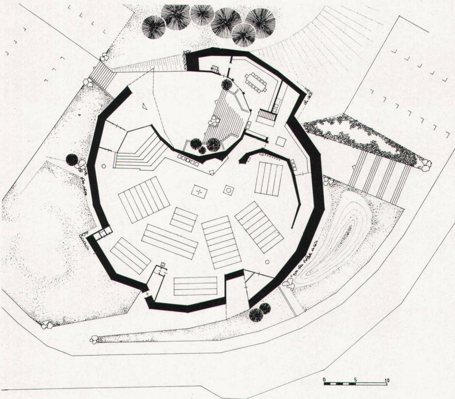
Die St.-Antonius-Kirche in Wildegg ist eine stützenfreie und fensterlose Halle für 350 Plätze. Das zeltartige Innere wird durch drei in das Dach eingelassene Oblichter erhellt. Die Wände sind Sichtbackstein und rohbelassenes Tannenholz, die plastische Außenform ist ganz mit Kupfer verkleidet. Für die Beichte dienen niedrige Raumnischen, an die die Sprechzimmer anschließen. Im Untergeschoß ist ein Pfarreisaal mit Bühne und Foyer, unter dem Turmaufbau befinden sich weitere Nebenräume
