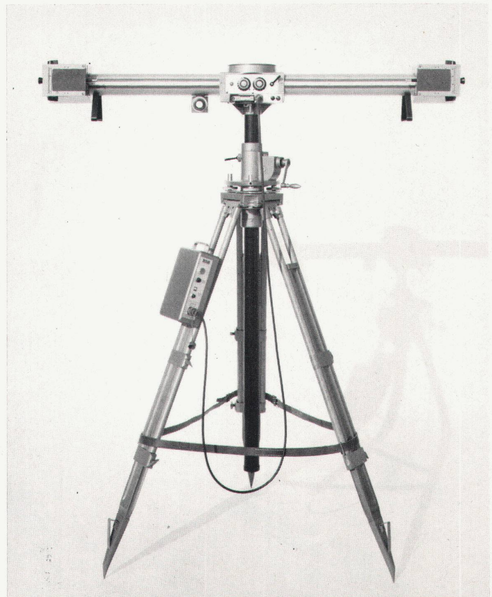
Abb. 6 Individuelle Messkammer: Wild P31, Brennweite 100 mm, Bildformat 4 × 5".
