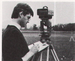
Citation Das neueste elektronische Vermessungsinstrument im Wild-Programm: der reduzierende Infrarot-Distanzmesser Citation CI-450. Bemerkenswert ist das grosse Bedienungs-/Ablese-Panel. Der CI-450 ist hier auf den Skalentheodolit Wild T16 aufgesetzt.
