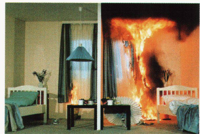
Nach 60 sec steht die herkömmliche Dekoration in hellen Flammen, das Feuer greift um sich. Dagegen schmilzt TREVIRA CS langsam ohne eigene Flamme ab. Ohne Zündquelle verlöscht der Brand, so daß Schwelbrände verhindert werden.
