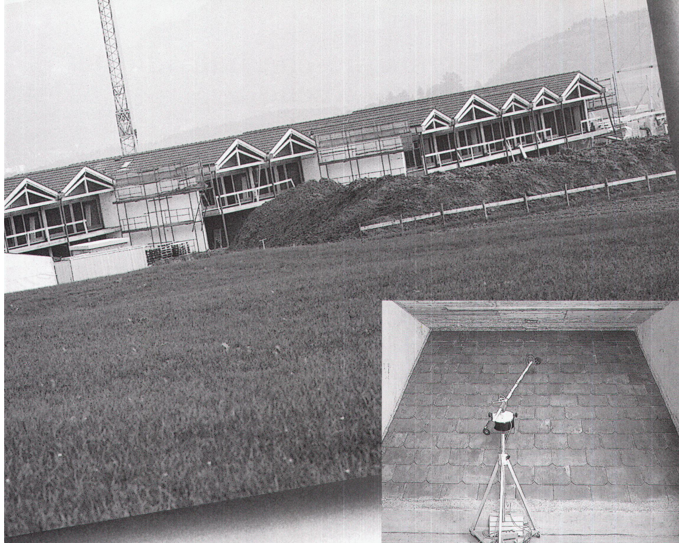
Luftschallprüfung am Grossmodell EMPA Zürich
