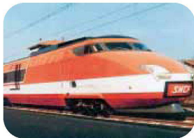
Prototyp des ersten TGV (train à grande vitesse); Gasturbinenantrieb, Design Jacques Cooper
