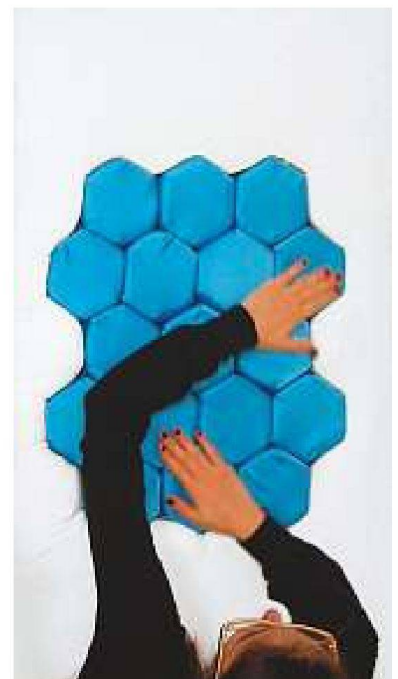
Projekt Sensitive Voxel: Prototyp eines multi-dimensionalen Tastrasters aus identischen Zellen, die mit Wärme, Kälte und Vibration auf unseren Tastsinn wirken können. Die Wirkung der darauf abspielbaren Muster ist verblüffend. Welche neuartigen Interaktions- und Kommunikationsformen sich mit solchen, sich überlagernden Mustern eröffnen, und ob neben therapeutischen auch Anwendungen im Bereich der interaktiven Architektur sinnvoll sind, soll nun mit einem interdisziplinären Forschungsprojekt untersucht werden. – Bild: I. Pohl
