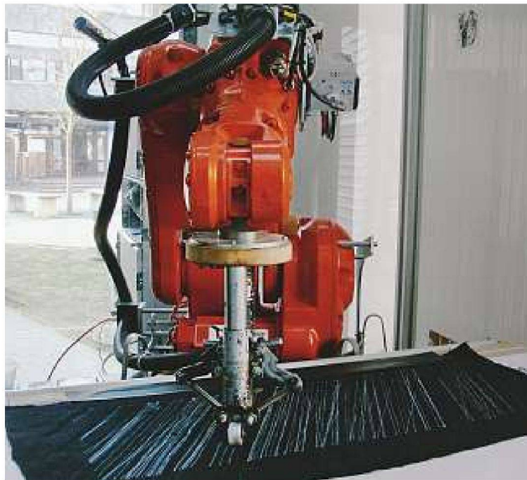
Projekt Papier Peint: Studierende programmieren einen Industrieroboter, um Tapeten zu bemalen. Die Maltechnik ebenso wie die Werkzeuge für die Fabrikation der jeweils auf eine bestimmte räumliche Situation massgeschneiderten Tapeten wurden im Rahmen des Studios von den Studierenden selbst entwickelt – eine digital erweiterte Handwerksarbeit. Hier: Tropfen von Bleichmittel auf dunkel gefärbtem Baumwollstoff. – Bild: http://iam.tugraz.at/studio/w10/
