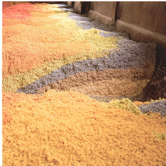
Eingefärbtes Linoleum-Granulat, ein wichtiger Bestandteil der Marmoleum-Rezeptur.
