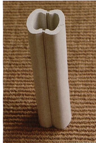
Gebrannte, unglasierte Fassadenfliesen mit Abstandhalter respektive «Back to Back» zur Stabilisierung beim Brennvorgang. Bilder: Susanna Anttila
