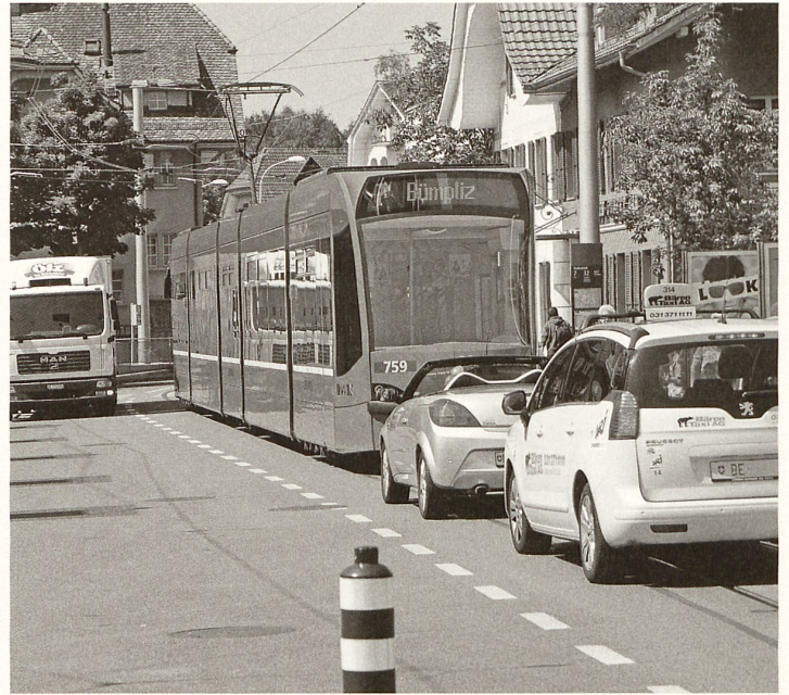
In Bern verkehrt das Tram auch auf Neubaustrecken im Mischverkehr und teilt die Fahrbahn mit Autos und Fussgängern. Bild: Hansueli Trachsel, Tram Bern West
