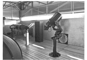
Die beiden Hauptteleskope verfügen über unabhängige Fundamente
