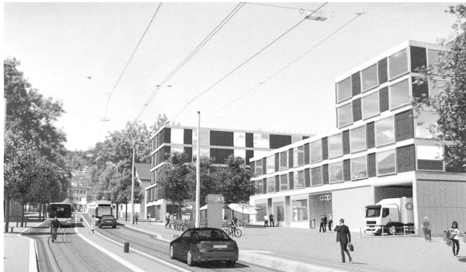
Bei räumlich beschränkten Verhältnissen in gewachsenen Siedlungsstrukturen kann das Tram abschnittsweise Mischverkehr mit Tempo 30 geführt werden wie hier im Zentrumsbereich von Zürich-Albisrieden. Visualisierung: Metron Verkehrsplanung
