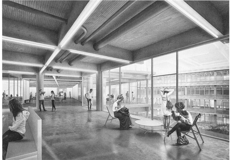
1. Rang, Pool Architekten: Informelle Lern- und Begegnungszone in den mittigen «Türmen des Wissens»; weitgespanntes Tragwerk mit Unterzügen aus Buchenholz.
