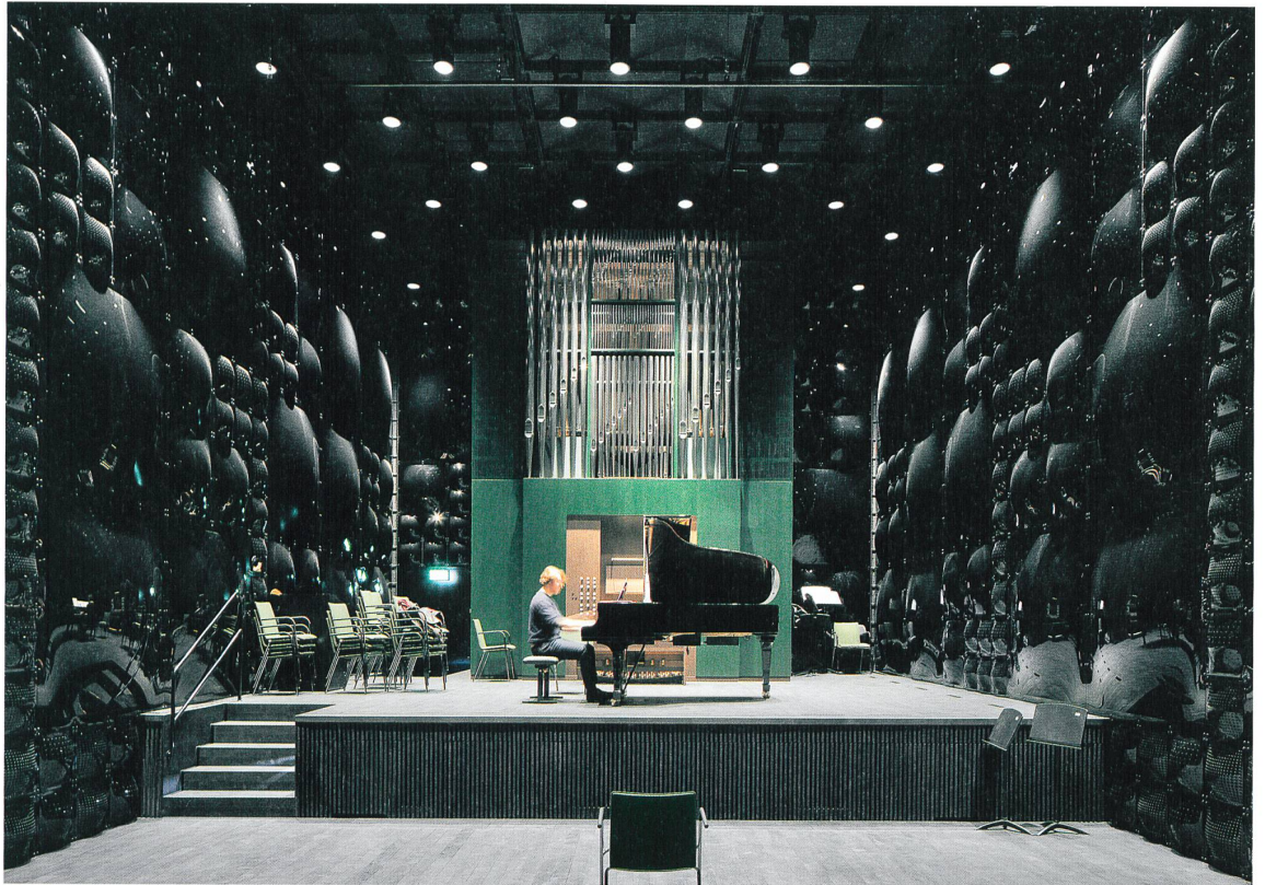
Kleiner Konzertsaal mit Akustik-Ornament aus eingefärbten Kuppelfenstern rund um die Orgel von Orgelbau Goll
