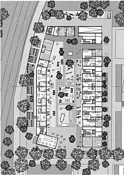
Der sorgfältig zonierte Hof bildet das Herz der Wohnanlage von Conen Sigl, ein abgeknickter Baukörper beherbergt das Quartierbistro.
