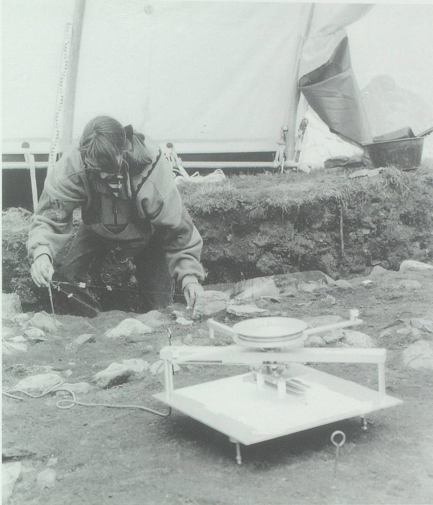
Abb. 2, Wartau, Ochsenberg: Plandokumentation mit dem Feldpantographen.
