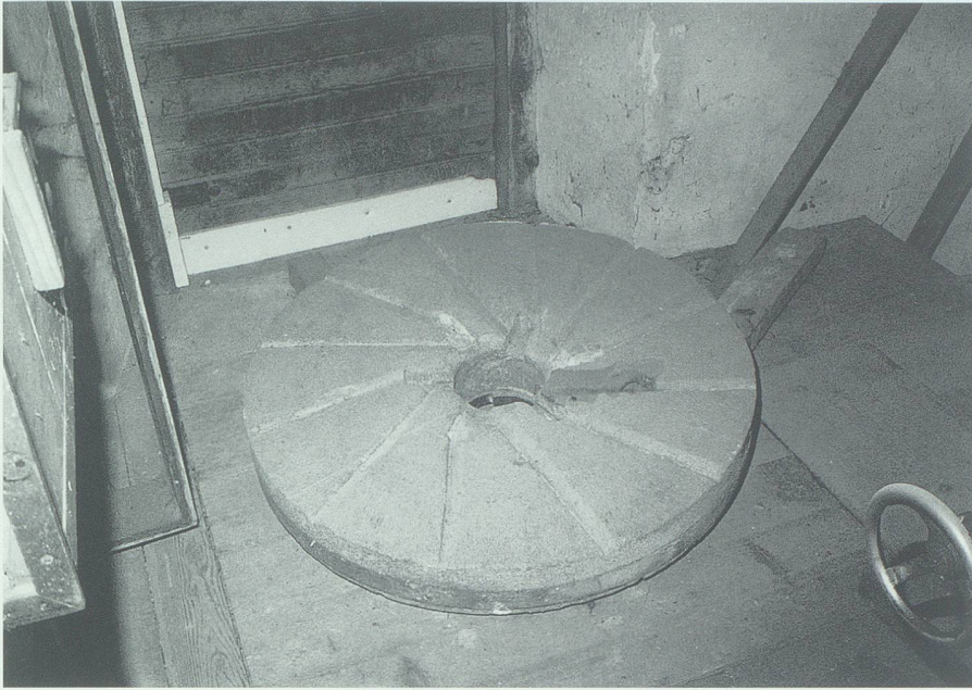
Der Mühlstein (Bodenstein) in der Mühle Forrer im Unterdorf.
