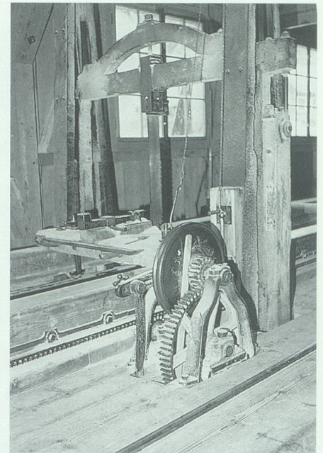
Eine einfache Gattersäge, wie sie früher in der Oberen Säge vorhanden war. Das Bild zeigt die Säge im Sägenboden, Wildhaus.
