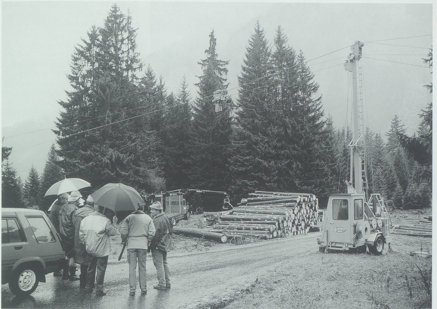
Einsatz eines Mobliseilkrans für die Holzbringung nach dem Sturm «Vivian» von 1990. Bild im Archiv des Kreisforstamtes Werdenberg.
