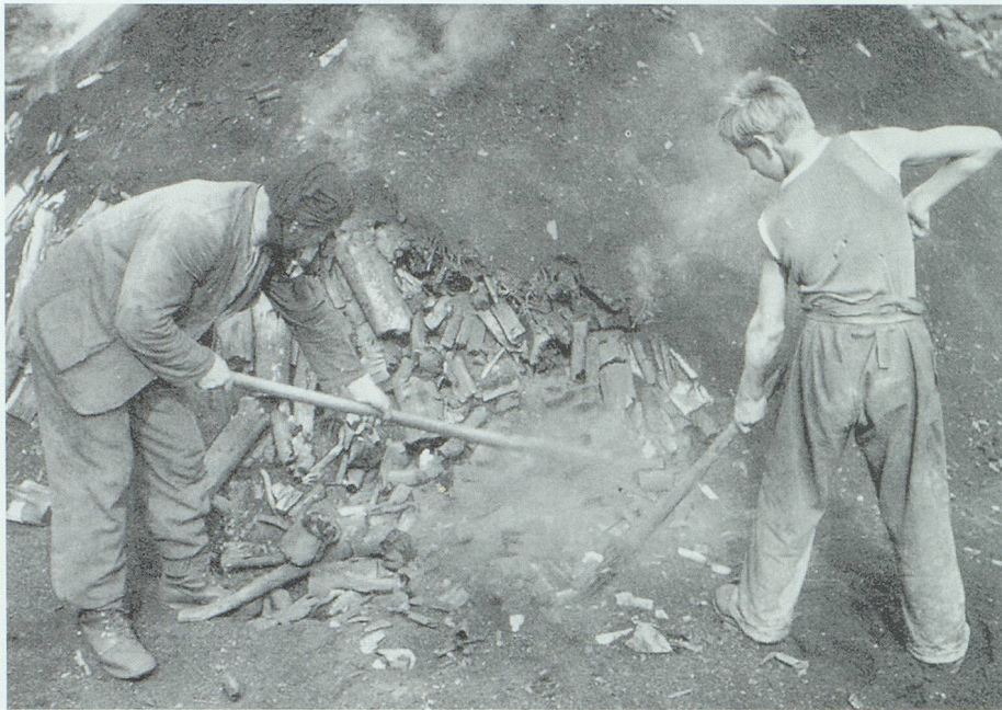
Der Meiler wird vorsichtig aufgebrochen und die Holzkohle mit dem Karst herausgezogen. Aus Gall 1/2003.
