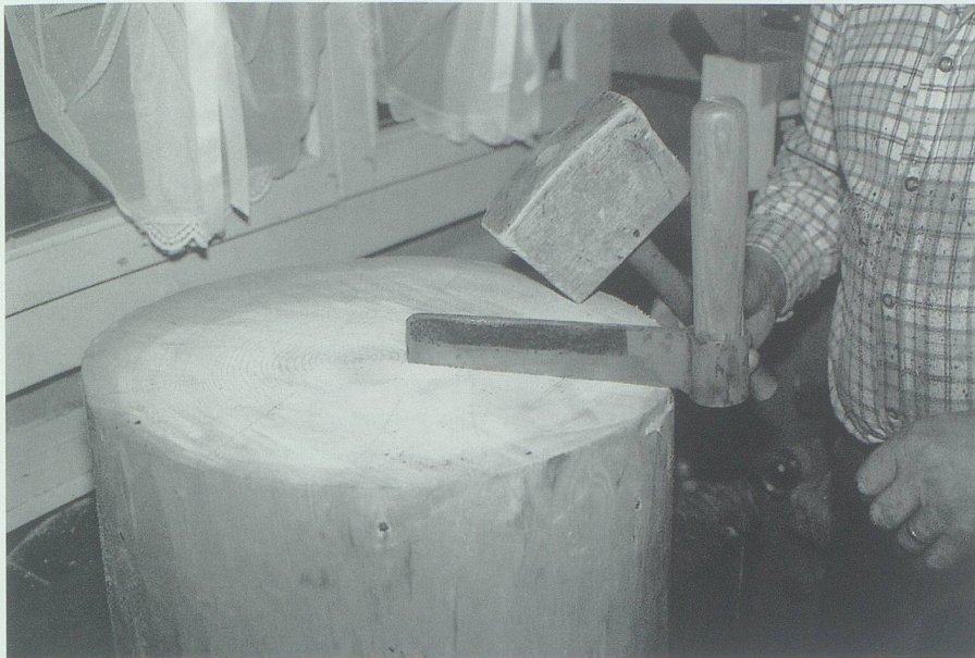
Aus dem geschälten und gehobelten Rohling werden die Möseln (oder Wiselen) geschlagen.
