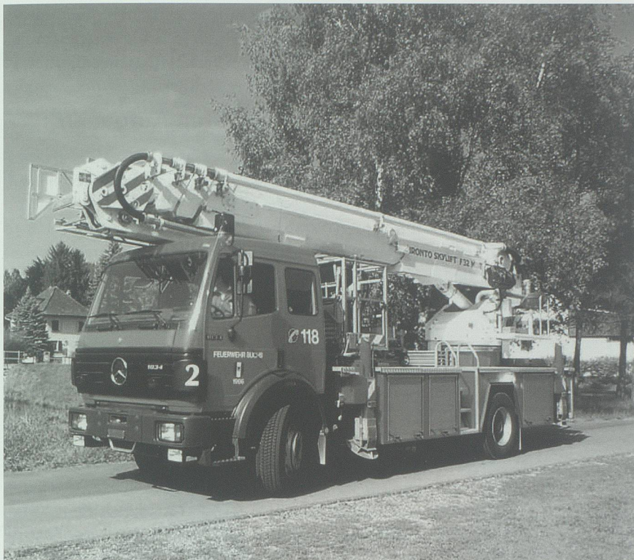
Das von Buchs im Jahr 2000 angeschaffte Hubrettungsgerät mit einer Einsatzhöhe bis 32 Meter wird auch regional eingesetzt.
