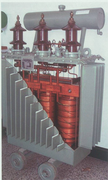
Abb. 5: Blick ins Innere eines Transformators. Wikipedia/GFDL
