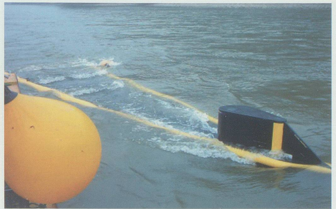
Die in Österreich entwickelte Stromboje ist grösstenteils im Wasser «versteckt». Aqua Libre Energieentwicklung GmbH
