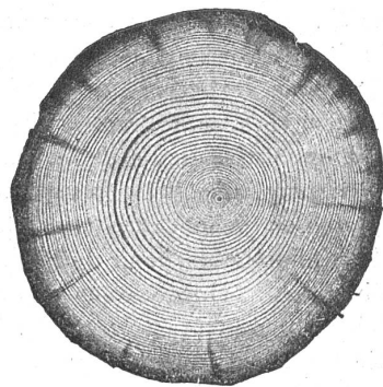
Abb. 2. Querschnitt von im Eintauchverfahren imprägnierter (Myanisierter) Rundhölzer.
