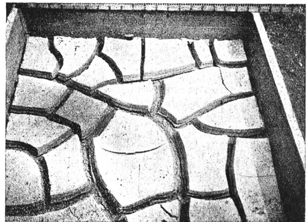
Abb. 12. Betontrog. Vollständig ausgetrockneter Lehm.
