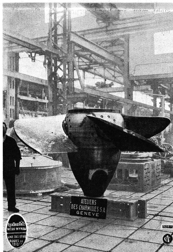
Abb. 6 und 7. Kraftwerk Wynau I. Leitapparat und Laufwerk der Kaplanturbine.
