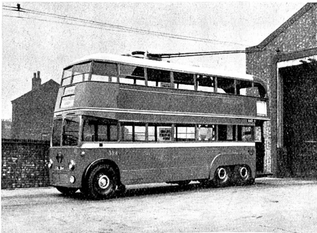
Abb. 12. Zweistöckiger Trolleybus von der Strassenbahn London, 95 PS, für 75 Fahrgäste, (70 Sitz- und 5 Stehplätze). Photo Leyland
