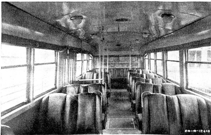
Abb. 27 Inneres eines amerikanischen Trolleybus mit 2,4 m Kastenbreite, mit je 2 Quersitzen links und rechts des Mittelganges.
