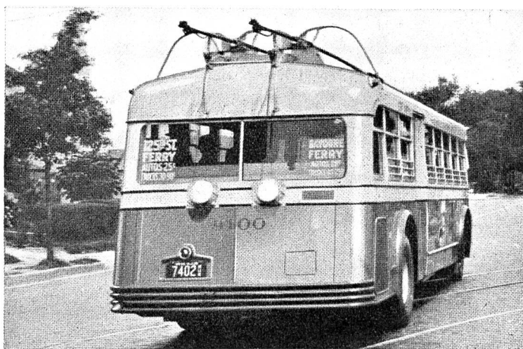
Abb. 33 Endgültige Bauart des in Newark entwickelten Zweikraftwagens. Das Bild zeigt einen der 430 vorhandenen Wagen mit abgezogenen Stromabnehmern als Diesibus laufend.
