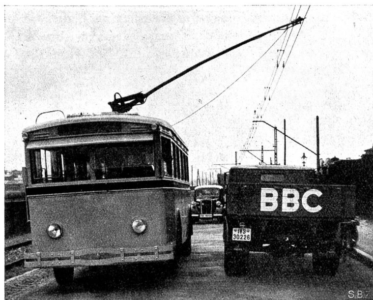
Abb. 29 Einstangen-Stromabnehmer und Vielfachaufhängung BBC.
