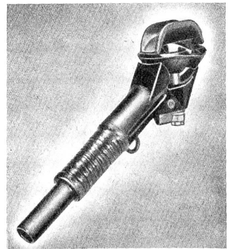
Abb. 28 Schleifschuh-Stromabnehmer für Trolleybusse (Bauart Ohio-Brass).
