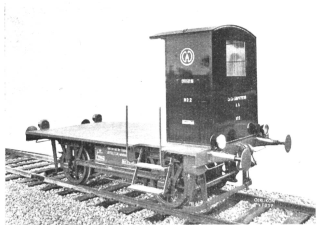
Abb. 4 Akkumulatoren-Kleintraktor 16 PS, Zuggewicht 48 t auf 23% Steigung.
