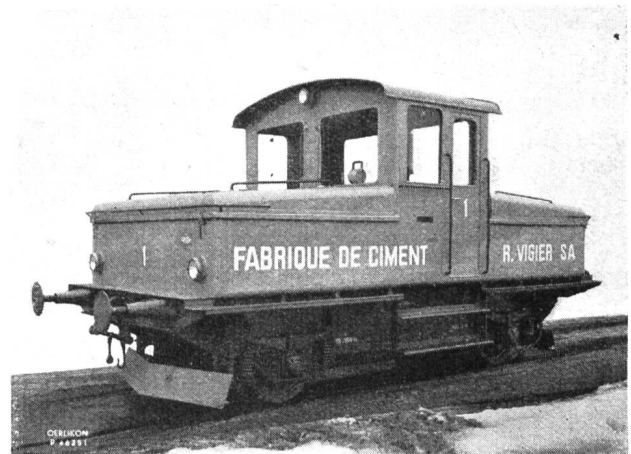
Abb. 2 Moderne Werklokomotive 100 PS, Aktionsradius 6400 tkm. Gewicht 25,5 t.
