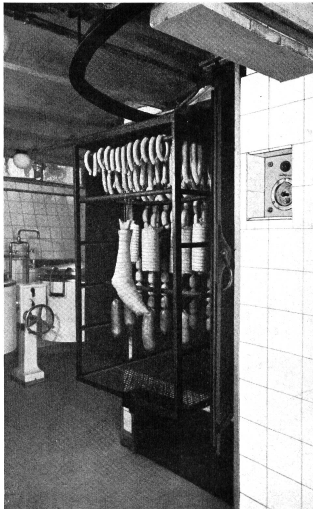
Fig. 4 Heissrauchanlage mit sichtbarer Temperaturskala (System II). Fumoir électrique avec échelle visible des températures (système II).
