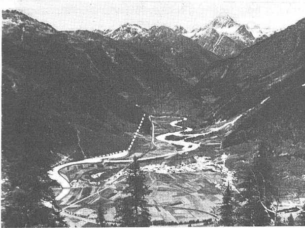
Abb. 1 Ansicht von Zernez, mit Blick gegen das Unterengadin. Links projektiertes Ausgleichbecken beim Bahnhof Zernez und linksseitiger Druckstollen, bis Clüts sichtbar. (Siehe Abschnitt 3, Seite 38.)
