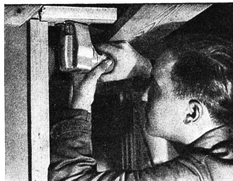
Abb. 18 Selbst «Überkopfarbeiten» lassen sich mit der Elektro-Handsäge mühelos ausführen (Scintilla)
