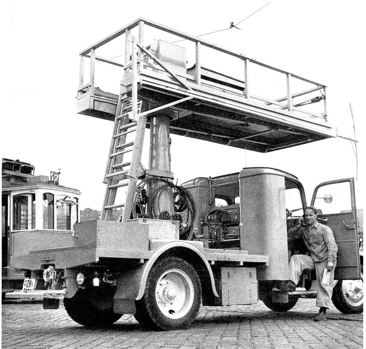
Vollautomatische Radioroxanlage der Industriellen Betriebe der Stadt Zürich Turmwagen der VBZ. Antennenstab auf der Kabine, Apparatur an der Rückwand und Sprech- stelle am Armaturenbrett.
