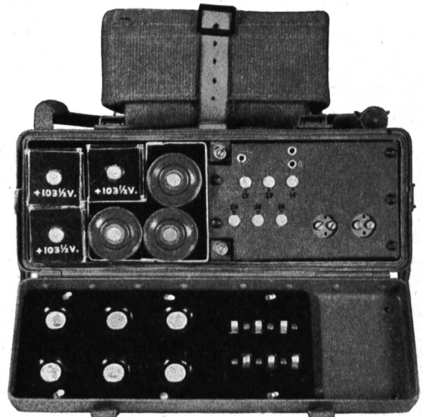
Links: Abb. 2, Gerät von oben. Konus mit Gewinde für die Antenne, Skala mit Drehknopf für die Kanalumschaltung, Schutzkappe auf der Steckdose der Sprechgarnitur, Blindstecker auf Steckdose der Fremdpeisung.
