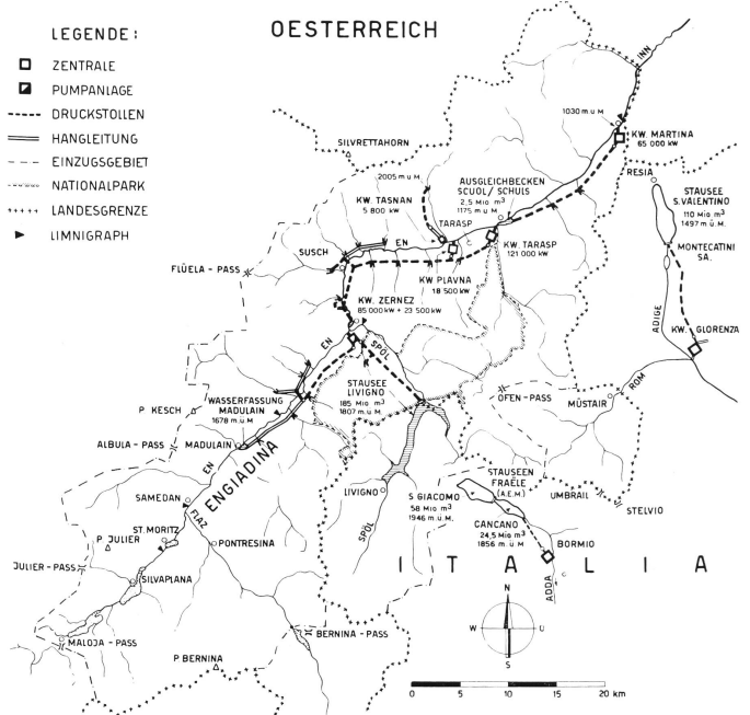
Plan 3 b Inn/Spöl-Projekt 1952 des «Konsortiums für Engadiner Kraftwerkprojekte» (KEK)
