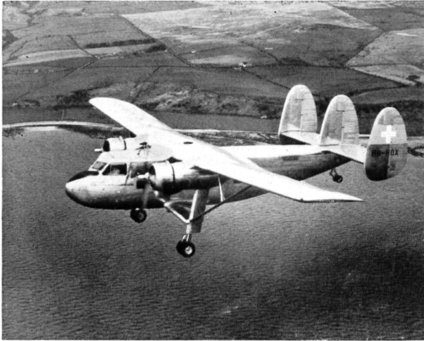
Bild 1 Kurzstart-Vermessungsflugzeug der Eidg. Vermessungsdirektion, Baumuster TWIN PIONEER der Scottish Aviation Ltd. Langsam fliegender Hochdecker mit 2040 kg Zulademöglichkeit und 6400 m ü. M. Gipfelhöhe (Fabrikaufnahme)
