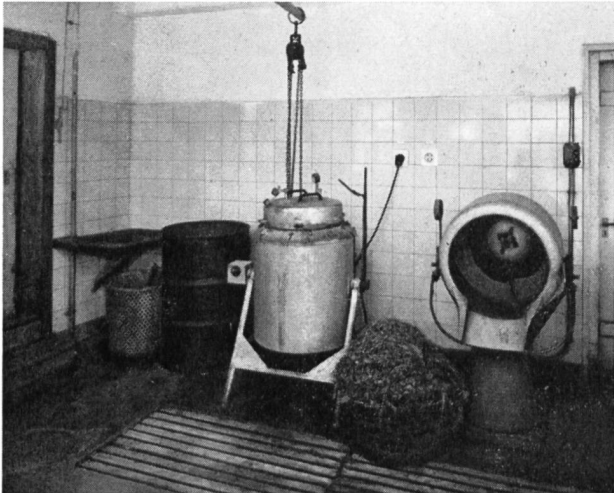
Bild 4 Futterküche für Schweine; links Futterdämpfer (Nachtstromverbraucher), rechts Muser und Mixer zur Herstellung von breiigen Futtermischungen
