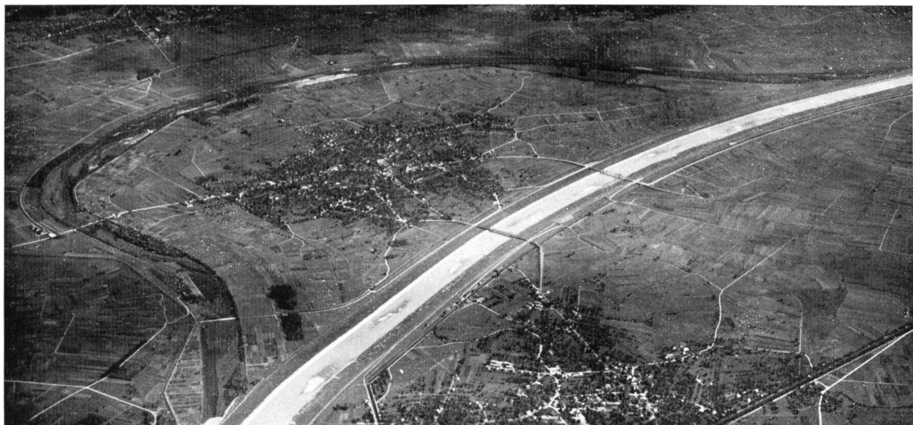
Fig. 2 Coupe de Diepoldsau, vue contre l'amont; à gauche l'ancien cours sinueux du Rhin.
