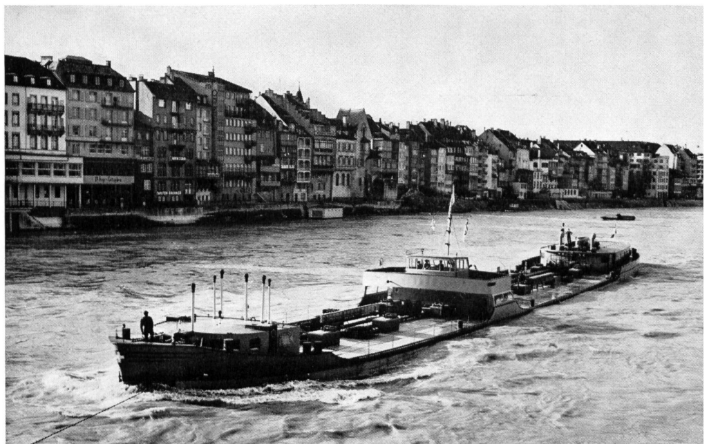
Bild 3 Ein «übergroßes» Motorschiff MTS «Piz La Margna» (1800 t, 1500 PS) bei der Fahrt durch Basel (Brag Tankschiffahrt AG)
