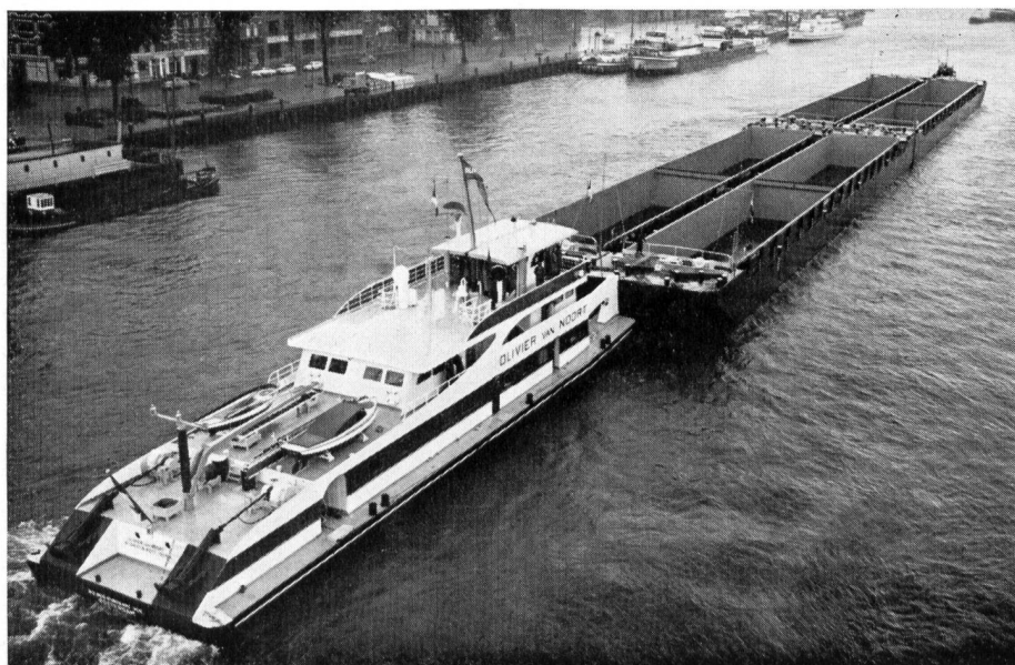
Bild 6 Schubschiffahrt Schubboot «Olivier van Noort» (1500 PS) mit 6 Behälterschiffen (Ladefähigkeit total etwa 9000 t) in Rotterdam (Nederlandsche Rijnvaart-Vereeniging)
