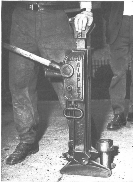
«Simplex» 20-t-Gelenkfußwinde Nr. 2030 mit 480 mm Hub und angepaßtem Ziegenfuß. Das Gas- und Wasserwerk Winterthur hat mit dieser Winde, so wie hier dargestellt, einige tausend Sondierpfähle ausgezogen.
