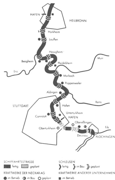
Bild 3 Neckarstrecke Heilbronn—Plochingen, Stand Ende 1960; Inbetriebnahme der Schifffahrt bis Stuttgart im Jahre 1958
