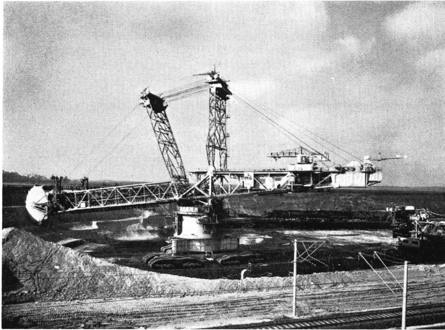
Bild 72 Besonders entwickelter Schaufelradbagger für den Großabbau der Braunkohle und des sie überdeckenden Materials. Bei einer Länge von rund 200 m, einer Höhe von rund 70 m und einem Gewicht von rund 7000 t — also etwa so schwer wie eine Rheinbrücke — können sie pro Tag rund 100 000 Kubikmeter bewältigen. Diese Geräte sind mit rund 165 Motoren ausgerüstet, ihr Stromverbrauch entspricht dem einer Stadt von 30 000 Einwohnern. Zur Bedienung sind in einer Schicht nur 5 bis 6 Mann erforderlich, während 20 000 Mann eingesetzt werden müßten, um die gleiche Tagesleistung von Hand zu erbringen. Ein vollständig ausgerüsteter Bagger dieser Art kostet 30 Mio DM.
