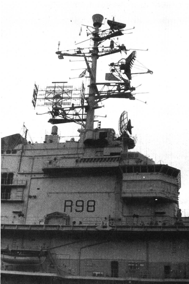
Bild 45 Detail der Radaranlagen des untenstehenden französischen Kriegsschiffes
