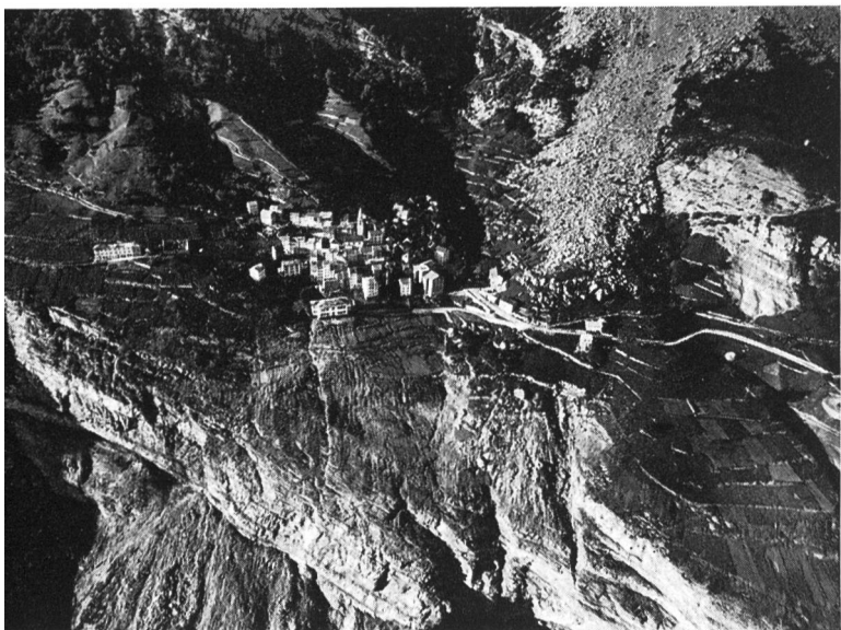
Fig. 23 Detailaufnahme des 200 m über dem Stauziel Vaiont gelegenen Dorfes Casso, bis zu dessen unterem Dorfrand die Flutwelle reichte und deutlich sichtbare Erosionsspuren hinterliess.
