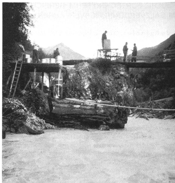
Fig. 2 Fig. 2, 3 und 4: Vergleichsmessung im Kochsalz- und Natriumbichromatverfahren.
