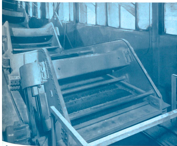
Resonanzschwingsieb Typ FA zur Absiebung von Schotter, Splitt und anderen Materialien Resonance oscillating screen type FA for screening of ballast and chippings, etc. Crible oscillant à résonance, type FA pour criblage de pierraille, grenailles et autres matériaux
