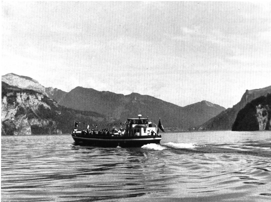
Bild 11 MS «St. Gotthard», das grösste und modernste Lastschiff auf den Schweizerseen auf seiner Jungfernfahrt. Dieses Schiff ist für den Sand- und Kiestransport auf dem Vierwaldstättersee bestimmt und verkehrt seit dem 1. Juni dieses Jahres in einem festen Fahrplan zwischen der Produktionsstätte in Flüelen und dem Handels- und Umschlagplatz Horw. Bei einer Geschwindigkeit von 18 bis 20 km/h (Antrieb durch 2 General-Motors Marine Dieselmotoren von je 230 PS Leistung) und einer Ladekapazität von 450 Tonnen kann das Schiff täglich 900 Tonnen = 520 m 3 Sand oder Kies von Flüelen nach Luzern bringen. Dies entspricht dem Fassungsvermögen von 104 Schwerlastwagen, die die stark befahrenen Strassen zusätzlich belasten würden.
