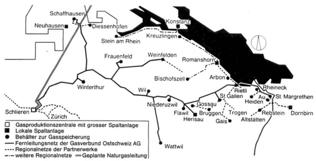
Bild 1 Fernleitungsnetz der Gasverbund Ostschweiz AG.
